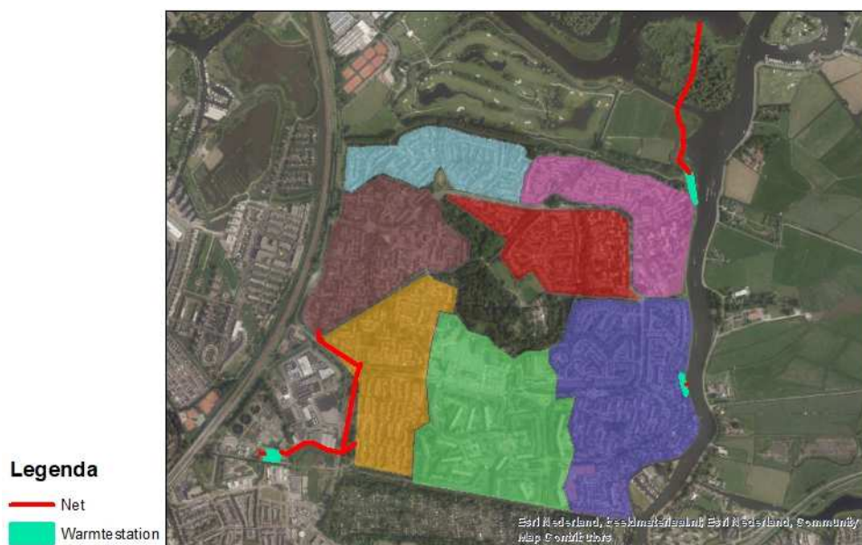
Figuur 3.1: (Hoofd)warmtestation per bron en leiding van bron (TEA of TEO met WKO) naar dit station
