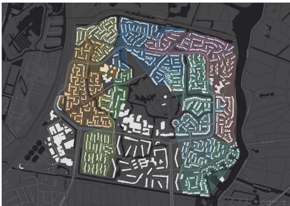
Figuur 4.7 Opzet ZLT hoofddistributienet met WKO én warmtepomp in de wijk met 70/40 wijkdistributienet
