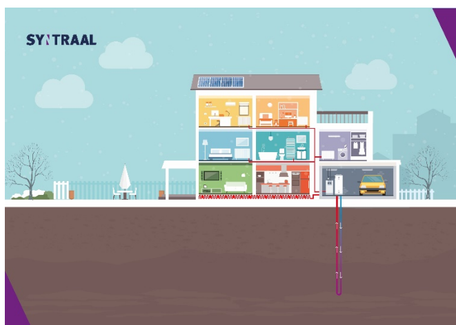
Figuur 4.13 Principe van een bodemlus in de winter
