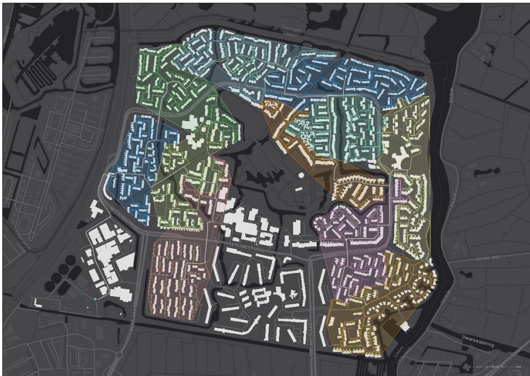
Figuur 4.3 Opzet warmtenet en clusters voor nieuw 70/40 warmtenet
